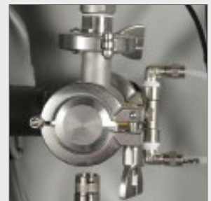
Orurowanie wykonane ze stali AISI 316L, z higienicznymi zaciskami hydraulicznymi tri clamp dostępnymi jako opcja.
